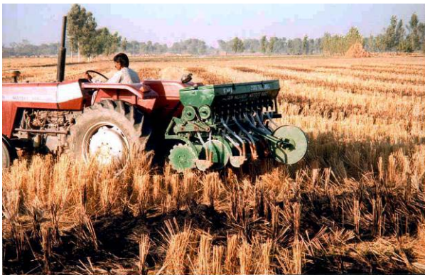
Fig. 1 FMI Dual Mode Zero Till Drill
