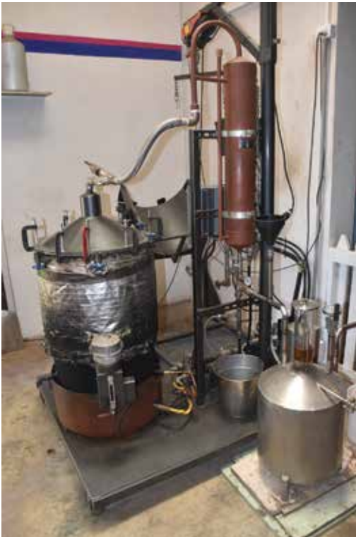
Figa 12.5 Oli yunit blong sandelwud distillesen we oli stap tritim ol jips wud wetem presa stim blong rilisim oel we i stap insaed.
