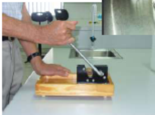
Wan manual machine blong brekem shell blong nangai we oli stap usum blong brekem shell blong Macademia
