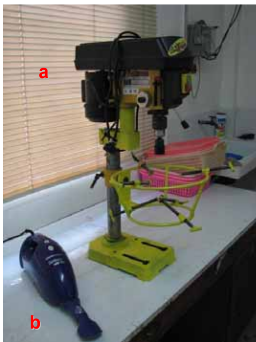
Hình 1 a) Bàn khoan tạo lỗ có giá đỡ quả dừa; b) Máy hút bụi cầm tay
