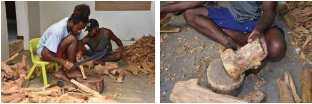
Figura 10.5 Prosesamentu sekundáriu manual ai-kameli bainhira vestíjiu ai-isin sira hotu ko'a sai husi ai-dudun
