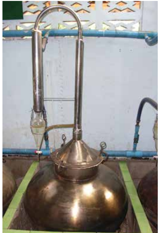
Figura 12.5 Unidade destilasaun mina ai-kameli sira ne'ebé mak ko'a tiha tratadu ho bee suar iha presaur nia okos atu hasai mina husi nia laran
