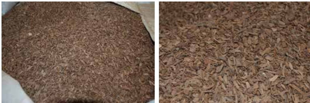
Figura 12.1 Ai-dudun tuku rahun ba espesifikasaun dimensaun konsistente (klase) ho chips 3-5 mm, ne'ebé uza ba estrasaun mina
