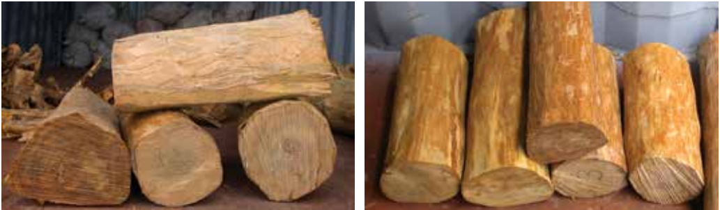
Gambar 11.13 Gelondong kayu ukir dengan gubal yang telah dihilangkan (kiri), dan gelondong kayu teras yang benar-benar bersih (kanan)
