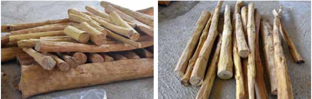
Gambar 11.6 Billet atau kayu gelondongan kecil – bagian dahan dan tunggul dengan gubal yang dihilangkan, berdiameter kecil dengan panjang 30–100 cm dan diameter 3,5–10 cm pada ujung terkecil
