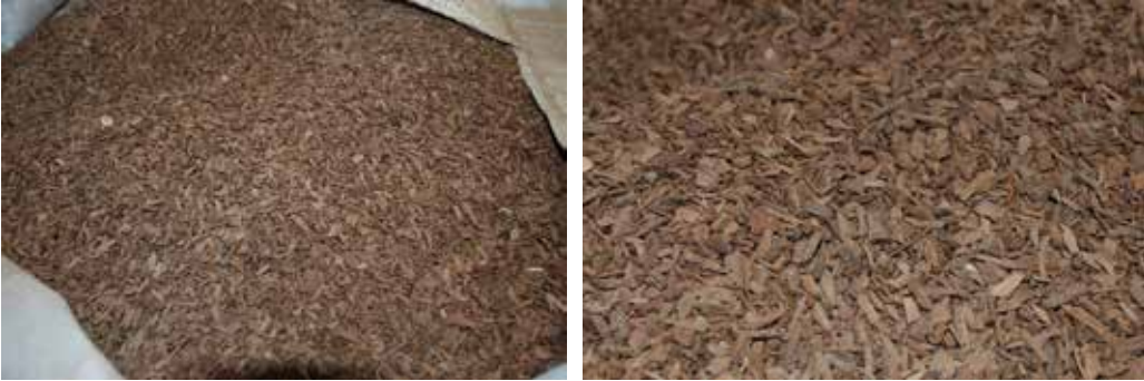
Gambar 12.1 Kayu teras digiling dengan spesifikasi ukuran yang konsisten (sesuai peringkat) menjadi kepingan 3–5 mm, yang lalu digunakan untuk ekstraksi minyak
