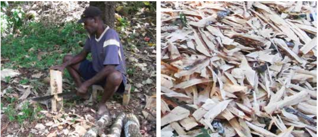
Gambar 10.4 Pembuangan kulit kayu dan gubal (kiri), dan kepingan kayu gubal sebagai produk sampingan (kanan)
