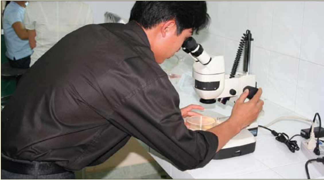
Hình 6.1 Kiểm tra các tản nấm dưới kính lúp soi nổi
