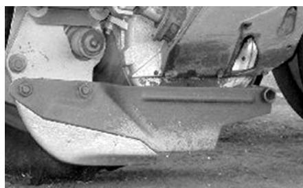
شکل ۵۱. نمونه ای از شیارباز کن کفشکی کامل.
