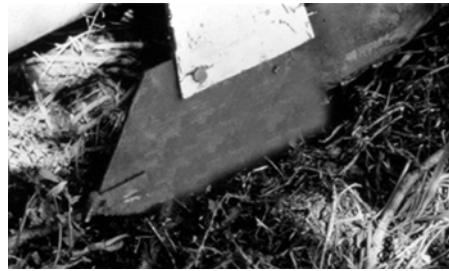
شکل ۵۲. نمونه ای از شیارباز کن کفشکی ناکامل.
