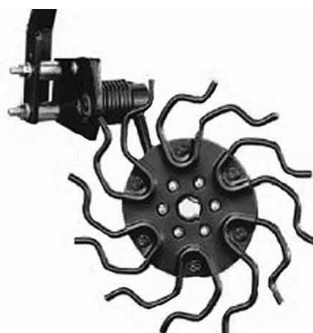
شکل ۳۱. ردیفساز چرخ انگشتی دار با انگشتیهای فولادی فری.
