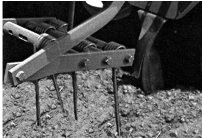
شکل ۳۹. نمونه‌ای از ردیفساز چنگه‌انگشتی.
