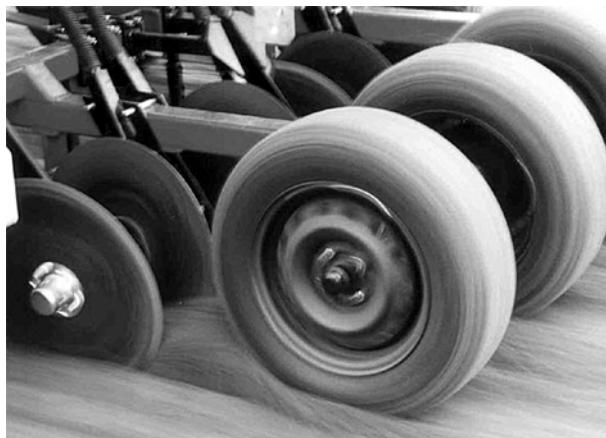
شکل ۶۸. شیاربازکن‌های تکبشقابی مقابل هم که یک چرخ فشار مشترک دارند.
