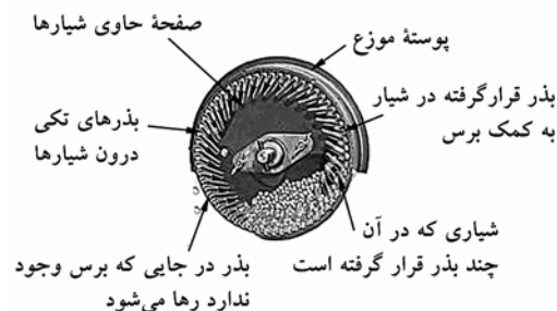
شکل ۱۸۷. مقطع عرضی موزع صفحه عمودی مجهز به برس جداکننده.
