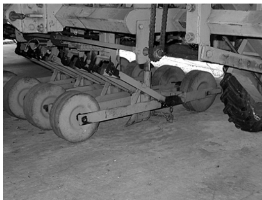
شکل ۱۶۲. کنترل عمق به کمک بازوی کشنده و سیستم جفت‌چرخ تنظیم عمق.
