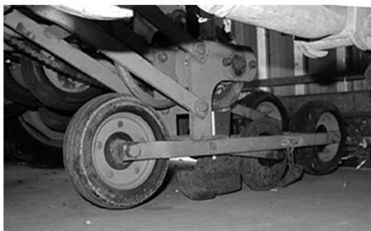
شکل ۱۵۷. یک شیاربازکن که در آن برای کنترل عمق از قاب متوازی الاضلاع و به کارگیری چرخهای تنظیم عمق دوتایی (جفت چرخ) استفاده می شود.
