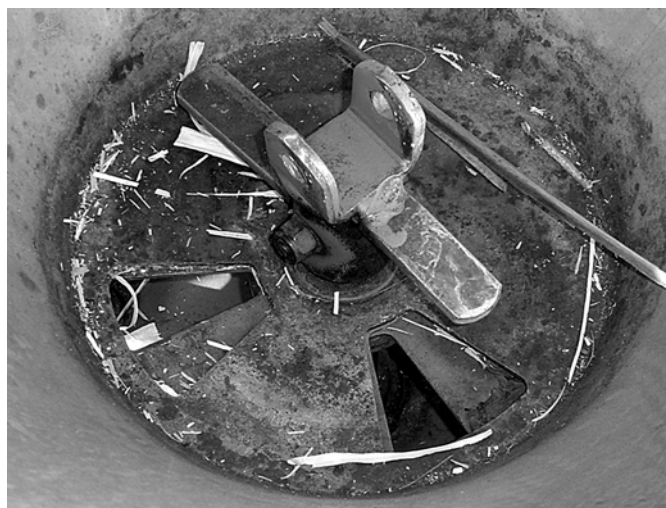
شکل ۱۶۴. موزع دریچه‌ای با صفحه لغزنده برای تنظیم اندازه دهانه‌های خروجی.
