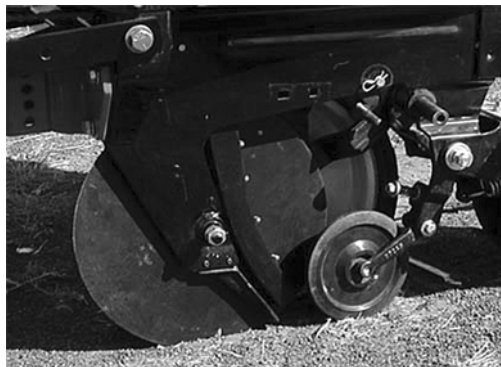
شکل ۲۰۲. تحویل بذربه شیار بر اثر نیروی ثقل و از طریق لوله سقوط انحراف یافته به سمت عقب در قسمت انتهایی آن.
