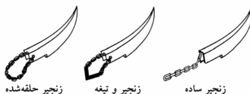
شکل ۱۰۶. حالت‌های مختلف به‌کارگیری زنجیر به‌عنوان پوشاننده بذر در شیار.
