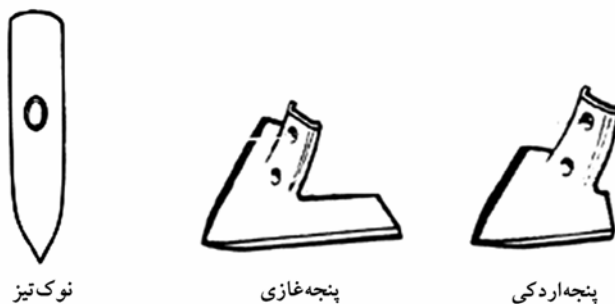
شکل ۹۲. انواع کلی شیاربازکن‌های دو منظوره.
