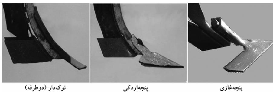
شکل ۹۳. انواع شیاربازکن‌های قلمی دو منظوره رایج (نوک دار، پنجه اردکی و پنجه غازی).
