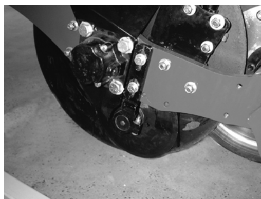
شکل ۷۰. ابزار قراردعی بذر در شیار از نوع دیسک چرخان در یک شیاربازکن تک‌بشقابی تک‌زاویه‌ای.
