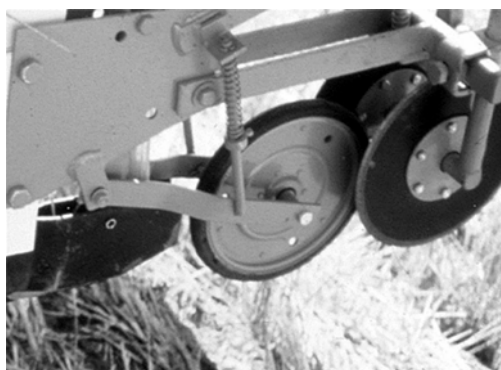
شکل ۱۱۱. پوشاننده دوشقابی ساده که بعد از چرخ تحکیم بذر قرار گرفته است.
