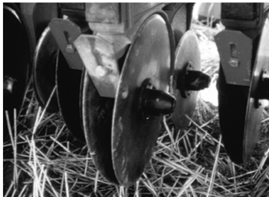
شکل ۸۰. نمای عقبی یک شیاربازکن سه بشقابی یکپارچه.
