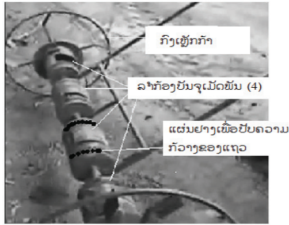
ຮູບ.4. ເຄື່ອງຢອດເມັດເປັນແຖວ(ລຳກ້ອງ) ເພື່ອການປູກໂດຍກົງ (ດັດແກ້ເພື່ອສາມາດປັບຄວາມກ້ວາງຂອງແຖວ ສຳລັບເງື່ອນໄຂແຕກຕ່າງກັນ).
