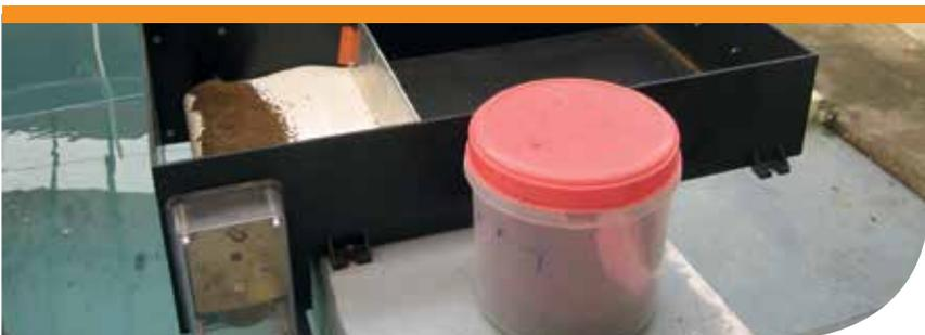
**Gambar 18** *Belt feeder* digunakan untuk memberi makan pelet pada kerapu muda—suatu mekanisme yang dioperasikan dengan baterai mendorong sabuk secara perlahan, menjatuhkan pakan ke dalam tangki. Jumlah pakan yang disimpan di sabuk, dan posisinya, menentukan tingkat dan pola makan. (Foto: M. Rimmer)
