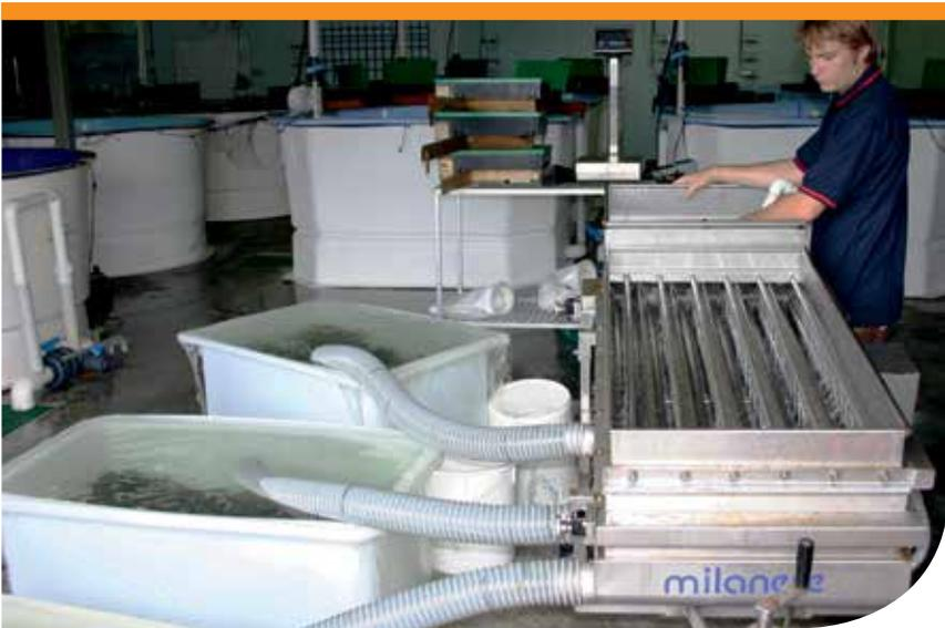
**Gambar 13.** Alat sortir komersial ikan bersirip di Australia digunakan untuk menyortir kerapu macan. Bibit-bibit ikan berenang menuruni saluran yang secara bertahap bertambah lebar celahnya—ikan yang berenang akan jatuh melalui celah diantara saluran, dan selang penghubung akan mengantarkan ikan ke tangki terpisah. Meskipun relatif mahal, alat sortir komersial seperti ini mampu menyortir sejumlah besar ikan lebih cepat daripada alat sortir manual. (Foto: R. Knuckey)
