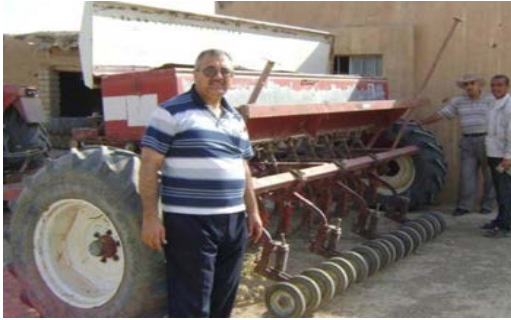
شكل 29: قام المزارع غازي فتحي من الموصل / العراق بتحويل بذارة راما التقليدية إلى بذارة بدون حرث ZT، وقام بتركيب عجلات ضاغطة محلية.
