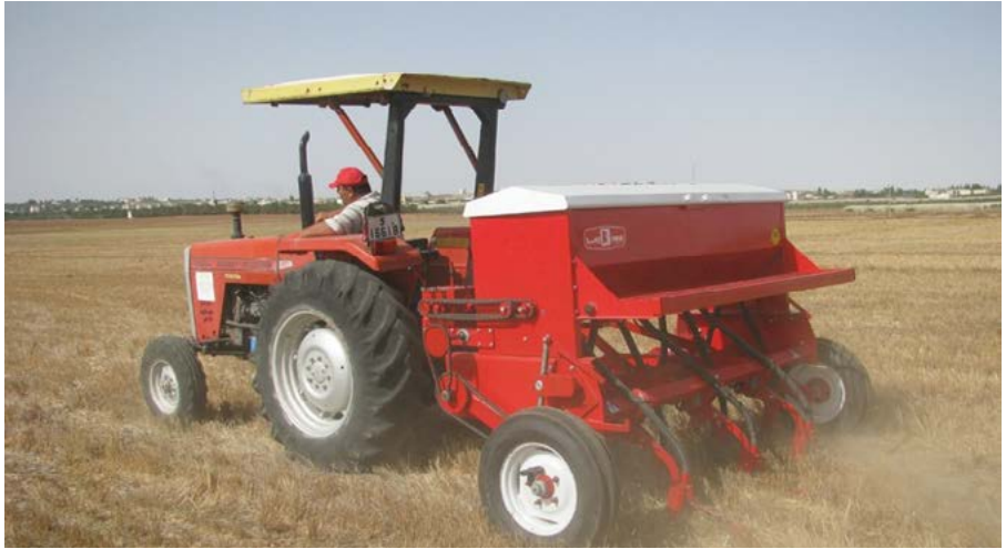
شكل 34 مثال لبذارة راما المعلقة فجاجية النوع مزدوجة الصناديق (سماد وبذار) وها عشرة فجاجات وبعرض 2.3 م، ومصنعة في الأردن عام 2014، وبكلفة تقديرية 7000 دولار أمريكي.
