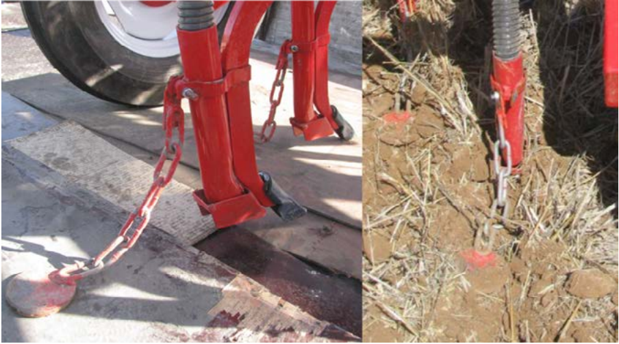
شكل 27: سلسلة التغطية 'snake chain' مثبتة إلى الفجاج وتنتهي بقرص معدني وتعمل كألة تغطية بسيطة في بذارات الزراعة بدون حرث ZT ومناسبة جداً لظروف الترب الخفيفة.
