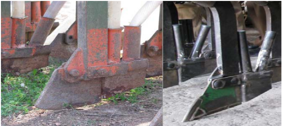
شكل 20: شفرة سكينية متآكلة بشكل سيء إلى اليسار مع تشوه حافتها الأمامية بشكل مستدير أو منحني يجول دون اختراقها للتربة بشكل فعال مقارنة مع مثيلتها الجديدة إلى اليمين.
