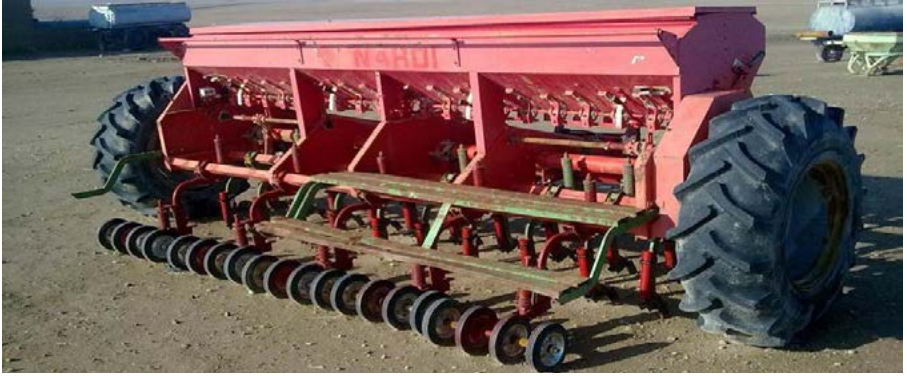
شكل 50: بذارة ناردي تقليدية محورة إلى بذارة زراعة حافظة مضافاً إليها عجلات ضغط مصنعة محلياً في الموصل - العراق.
