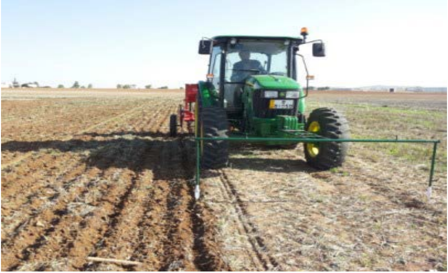
شكل 37 مثال لذراع علام بسيط ورخيص، وقد طُوّر عن طريق فني إيكاردا في محطة بحوث المشقر في الأردن، وذلك لتجنب التراكم أو الفواصل بين أشواط الزراعة.
