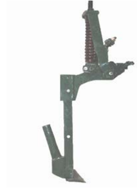
شكل 18: أمثلة من أنظمة البذر في استراليا - نموذج الفجاج النابضي البسيط إلى اليسار، ونموذج الديسك المفرد الثقيل مع عجلة ضبط العمق إلى اليمين.
